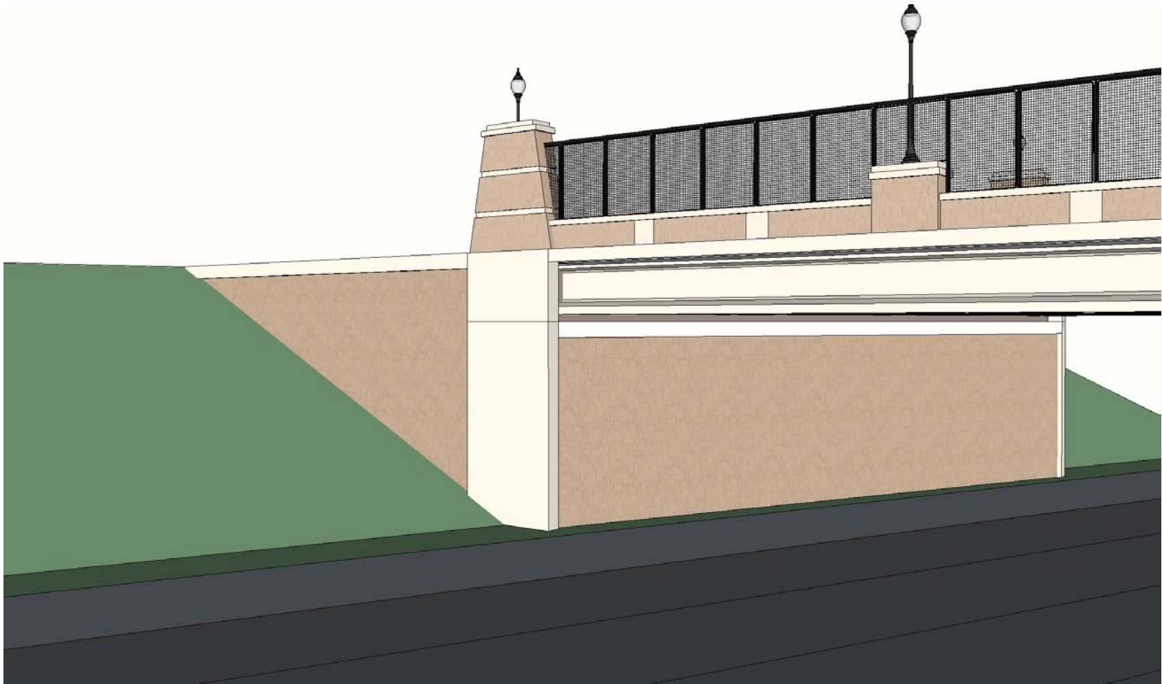
● RETAINING WALL AXONOMETRIC VIEW N.T.S.
